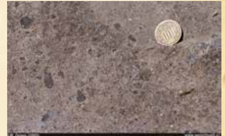
Figura 6D: Roca piroclástica, una toba litica: Con cantidades no menores de trozos de rocas incorporadas en la toba.
